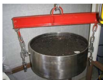
Slika 4. Uzorak otpada u edometarskoj ćeliji nakon završenoga pokusa
