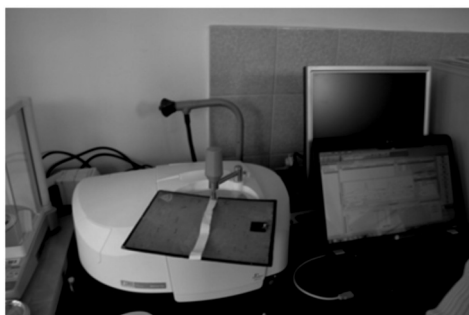
Slika 4. Neinvazivna metoda snimanja spektra izravno s objekta.
