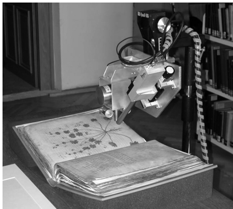
Slika 1a i 1b. a) Kodeks „Bečki Dioskurides“ i prijenosni XRF za vrijeme mjerenja u Nacionalnoj biblioteci u Beču. b) Usporedba spektara snimljenih na crvenom i dva smeđa slova.
