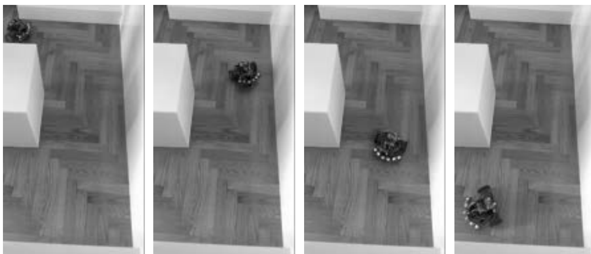
Slika 11. Primjeri izbjegavanja prepreka neizravnim upravljanjem mobilnog robota s diferencijalnim pogonom.
