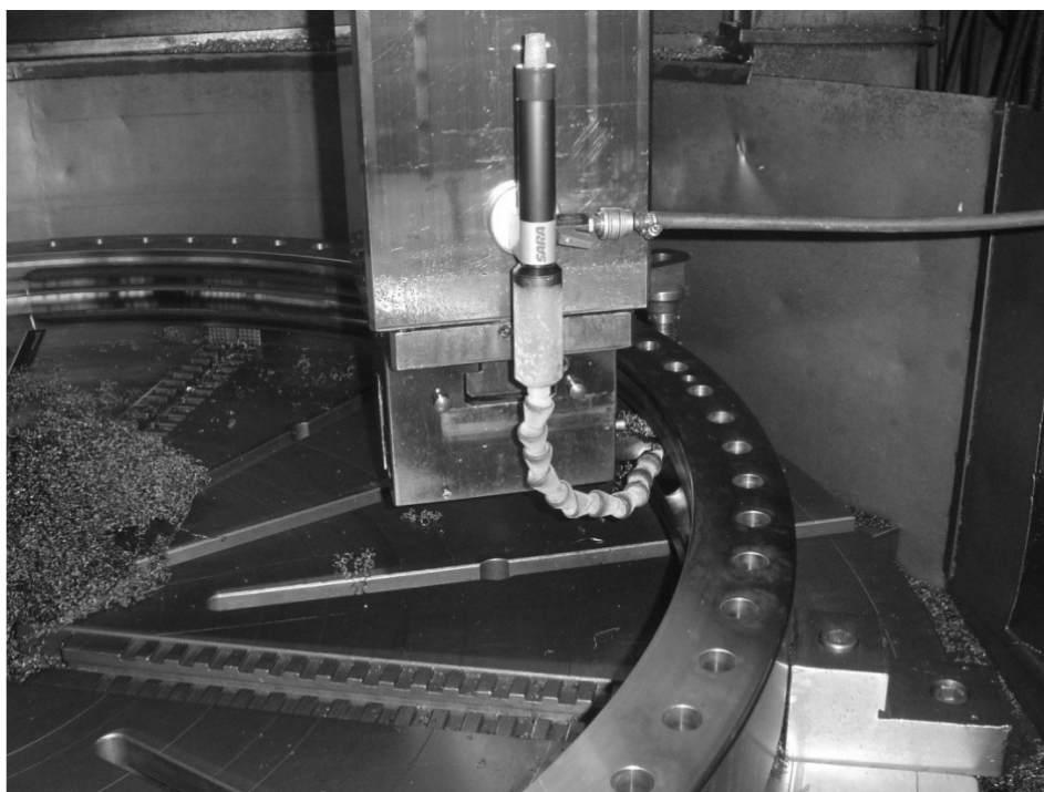
Slika 4. Završna obrada indukcijski zakaljene staze s točkastim hlađenjem
