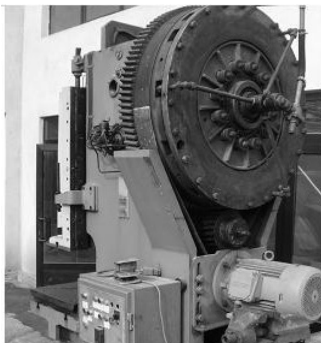
Slika 2. Ekscentar preša Jelšingrad nazivne snage 125 tona
