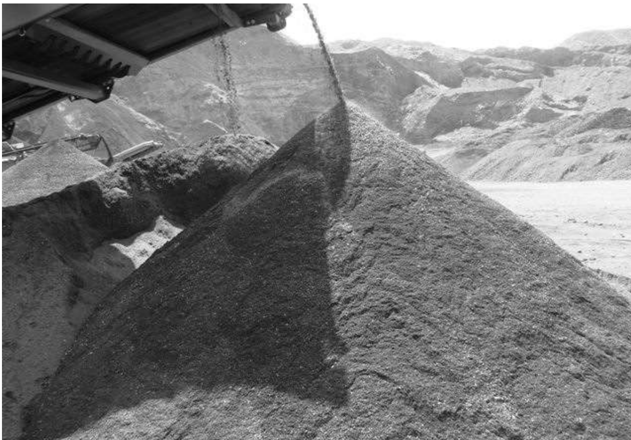
Slika 4. Dobivene sekundarne sirovine preradom troske
