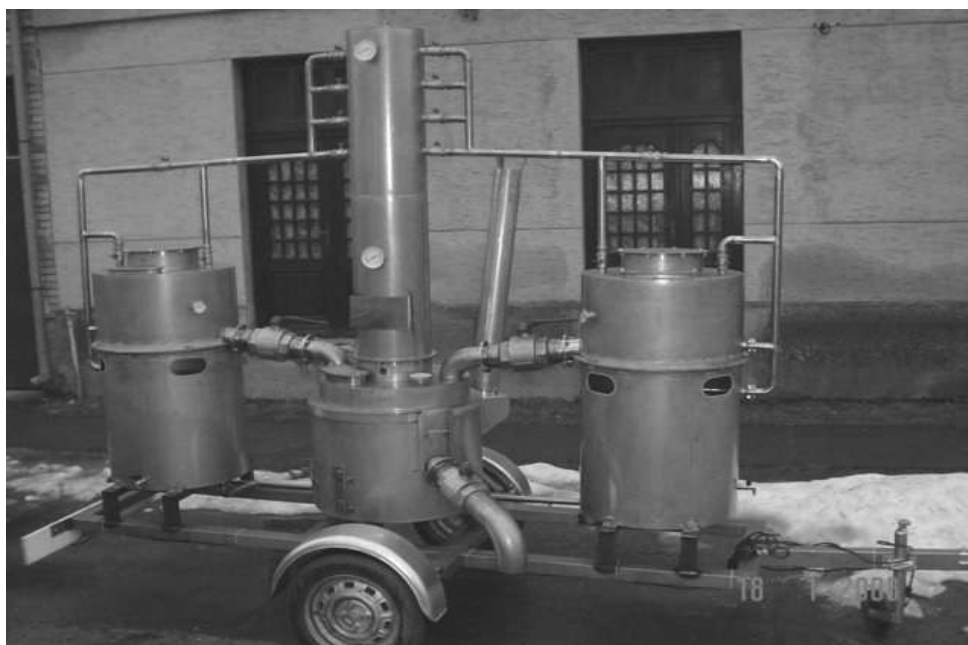
Slika 2.: Mobilno postrojenje za proizvodnju bioetanola „Jakobović“
