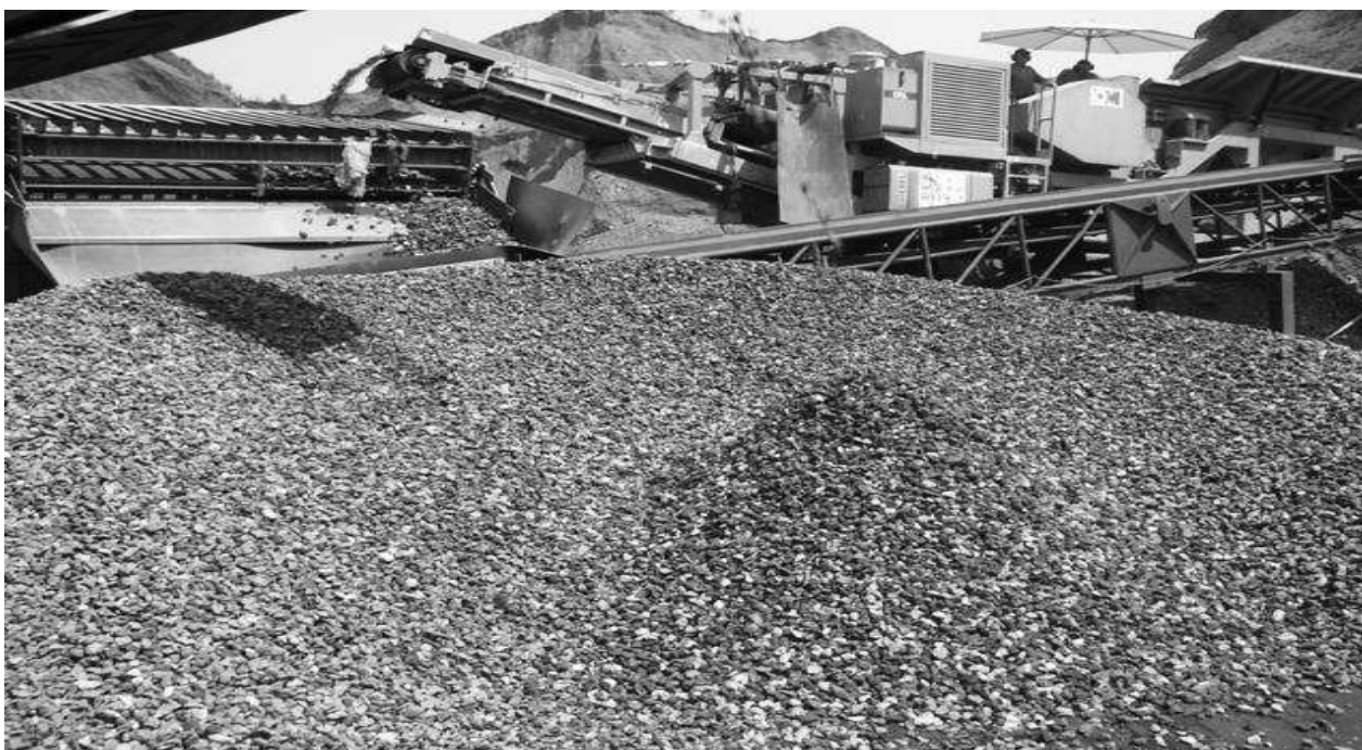
Slika 3. Dobivene sekundarne sirovine preradom troske
