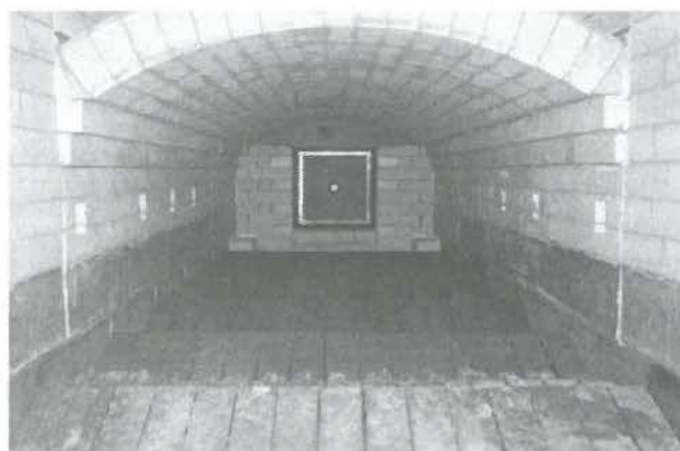
Slika 3. Unutrašnjost ložišta s vodoravnom rešetkom s koso položenim člancima
